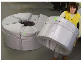
Hitzeschutz - Isolierungen werden aus thermisch hoch belastbaren Glasgeweben gefertigt. Diese Glasgewebe sind oftmals mit besonderen Beschichtungen ausgerüstet, damit sie zum Beispiel auch wetterfest oder Wasser abweisend sind.
